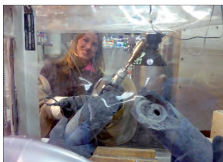
Figura 1. Obtención de muestras del subsuelo en condiciones anaerobias.
